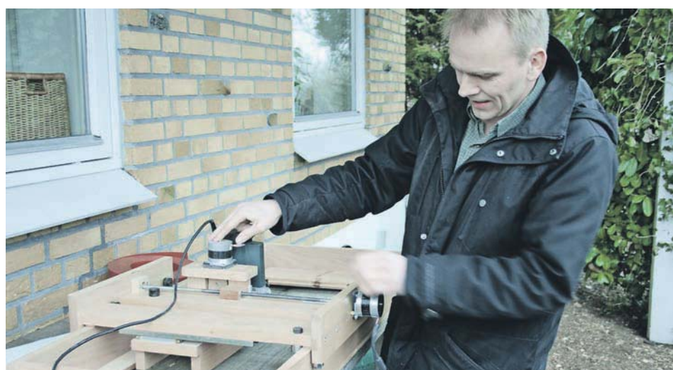
Peder Enevoldsens hjemmelavede tre-aksede robotfræser, der er bygget af nogle printermotorer, er hjemmets bevis på hans opfinder-interesse.
